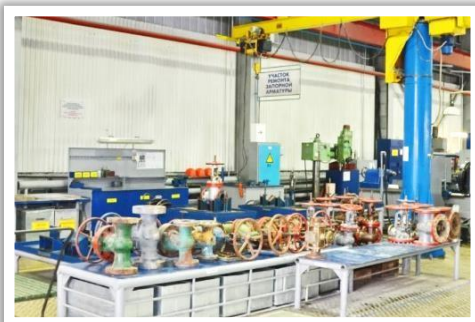
Ревизия и ремонт сбросных пружинных предохранительных клапанов, фонтанной и запорной арматуры
